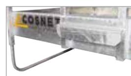
Attelage par barre à trous monobloc renforcée. Pied de type patin ski réglable en hauteur par boulons traversants.
