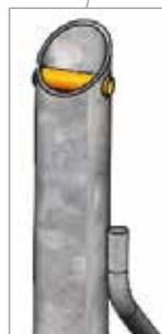
Axe de barre mobile équipé d'une bague de renfort limitant l'usure à long terme.
