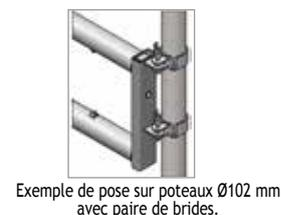
Exemple de pose sur poteaux Ø102 mm avec paire de brides.
