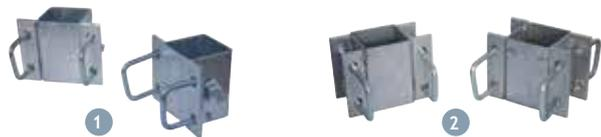
Ces brides sont prévues pour être fixées sur les poteaux de 80x80 mm. Les étriers sont prévus pour recevoir les poutres de 60x60 mm qui servent de fixation pour les bat-flanCS de logette. Les brides simples permettent une installation simple rangée et les brides doubles une installation double rangées.
