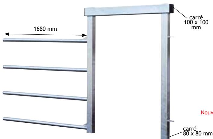
Très apprécié pour des utilisations en périphérie des robots de traite. Cadre mécanosoudé avec 2 montants en carrés de 80 mm traversant une poutre supérieure en carré de 100 mm, le tout repris sur les lisses en tubes Ø 48,3 mm renforcées par 2 goussets.
