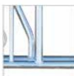
Barres d'encolure Ø 42,4 mm avec barres anti passage de tête, soudées sur le double panneau. Intervalles identiques aux barres d'encolure initialement montées sur un cornadis standard. Permet une plage de réglages d'encolure allant du libre-service (avec un dégagement total) à la réduction d'encolure, pour la prise de jeunes animaux.
