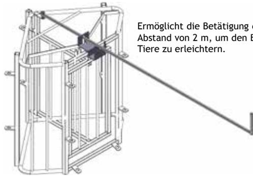
Ermöglicht die Betätigung des Tores aus einem Abstand von 2 m, um den Bewegungsdrang der Tiere zu erleichtern.
