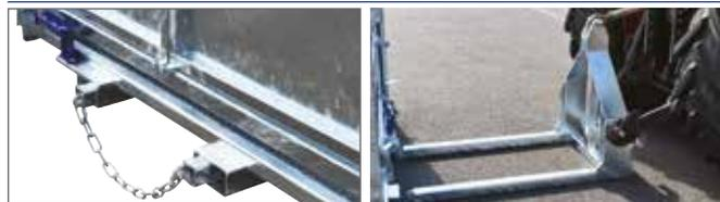
Dreipunktaufhängung (Kategorie 2) für Stände mit breitenverstellbaren Seiten. Aus maschinell geschweißtem Blech gefertigt, Wandstärke 12 mm. Hebearme aus 70 x 6 mm Rohr. Sicherheitskette Inbegriffen.
