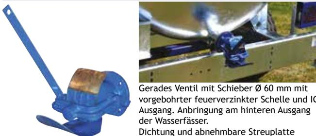
Gerades Ventil mit Schieber Ø 60 mm mit vorgebohrter feuerverzinkter Schelle und IG Ausgang. Anbringung am hinteren Ausgang der Wasserfässer. Dichtung und abnehmbare Streuplatte inbegriffen.
