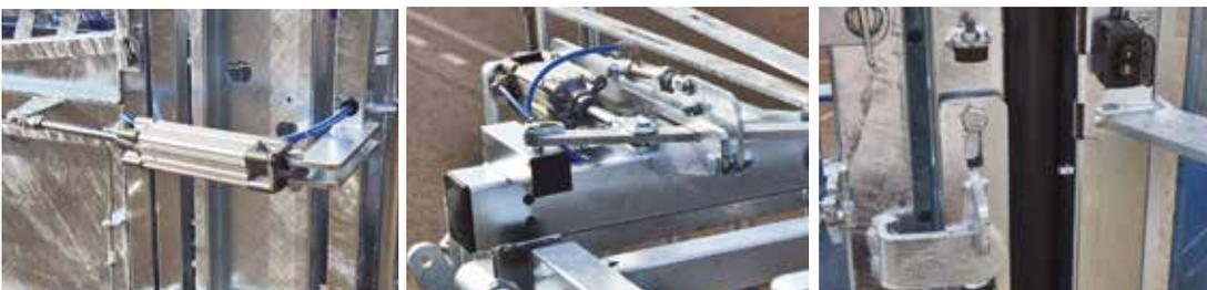
Pneumatikzylinder mit einem Druck von 5 bar. Der Zylinderdurchmesser ist auf die Kräfte abgestimmt, die zum Öffnen jedes Elements erforderlich sind.
