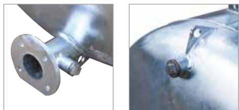
Hauptausgang hinten Ø 80 mm (3" 1/8) auf einer Platte mit 4 Bohrungen zur Befestigung der Ventiloptionen, Ausgang Ø 20/27 mm (3/4") mit Innengewinde auf der Seite des Hauptausgangs.
