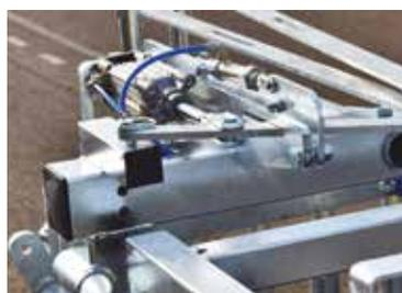
Pneumatikzylinder mit einem Druck von 5 bar.
