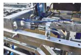
Pneumatikzylinder mit einem Druck von 5 bar. Der Zylinderdurchmesser ist auf die Kräfte abgestimmt, die zum Öffnen jedes Elements erforderlich sind. Jedes der Elemente, die von den Zylindern betätigt werden, ist mit einer mechanischen Sicherheit mit freiem Anschlag ausgerüstet, um die Beanspruchung und das Brechen der Zylinder einzuschränken, insbesondere bei Tierdruck.
