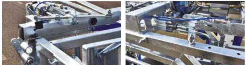
Pneumatikzylinder mit einem Druck von 5 bar. Der Zylinderdurchmesser ist auf die Kräfte abgestimmt, die zum Öffnen jedes Elements erforderlich sind.
