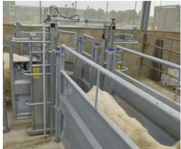
Eine pneumatische Steuerung mit einem Druck von 5 bar ist pro Steuerungskasten oder pro Automat des Standes erforderlich.
