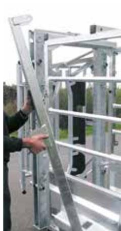
Dreipunktaufhängung, die für den Transport einklapppt werden kann und rechts oder links angebracht werden kann. Ermöglicht Behandlungen an der rechten oder linken Seite des Tieres.
