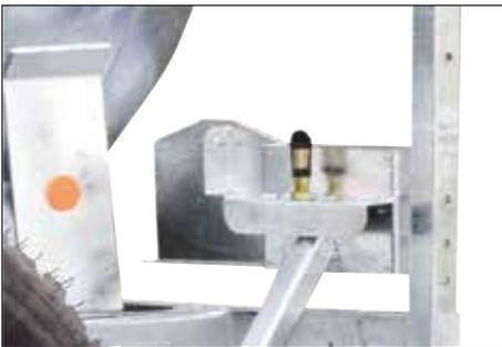
Geschützte Verkabelung, Anschluss für Drehlampe hinten.
