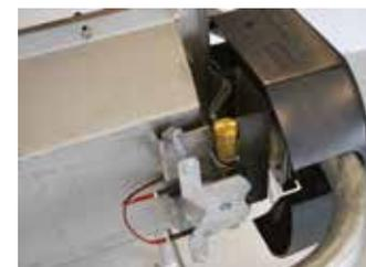
Polyrésistance chauffante 24 V - 80 W montée dans le carter de protection.
