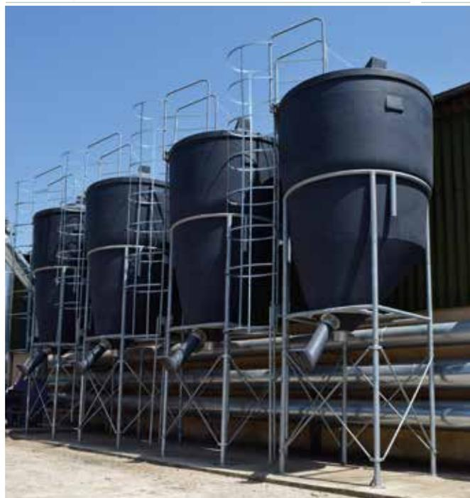
SILOS À ALIMENTS MONOBLOCS PETITE CONTENANCE SUR CHÂSSIS
