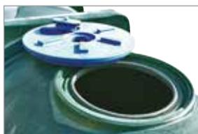
Large couvercle Ø 600 mm rotomoulé avec en son centre, un bouchon évent Ø 120 mm. Permet un passage d'homme aisé de Ø 500 mm pour les actions de nettoyage ou de maintenance
